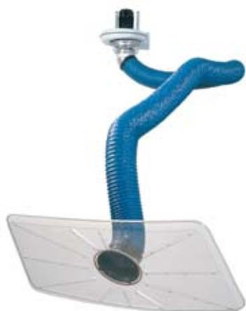
Вытяжной вентиляционный рукав Nederman для работы с ветровым стеклом автомобиля выполнен на основе рукава Original и специально предназначен для удаления паров клея, выделяющихся во время проведения работ по замене, демонтажу или установке ветрового стекла. Длина рукава – 4 м. Прямоугольная вытяжная насадка с узкой щелью вдоль края предназначена для удаления испарений при работе с клеем для ветрового стекла.
