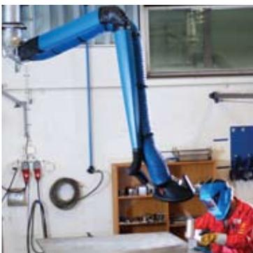
Ассортимент низковакуумных вытяжных рукавов производства Nederman предназначен для широкого спектра областей применения. Все рукава сгибаются во всех направлениях, легко раскладываются и фиксируются в одном положении, вытягиваются и втягиваются назад. Для крепления на стене, потолке или выдвигающихся крепежных кронштейнах предлагаются различные приспособления, а также ряд аксессуаров, включая насадки и заслонки для повышения производительности.
