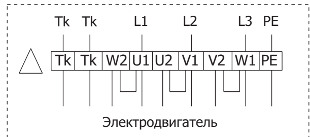
Схема подключения электродвигателя: UGW/D-[10-11]-TD;
